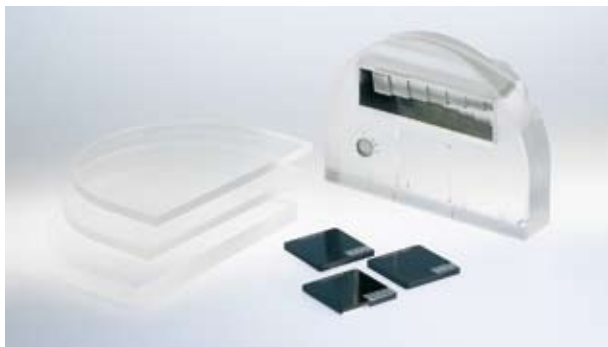
Abb. 1: Beispiel eines Prüfkörpers nach PAS 1054 für die Konstanzprüfung.
