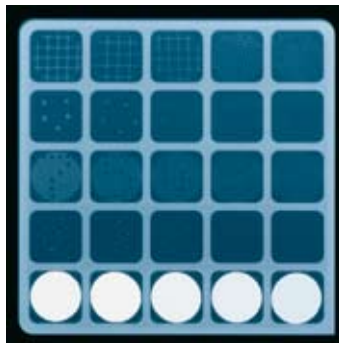
Abb. 2: Beispiel eines Testeinsatzes KP-MDP (Konstanzprüfung – Mammo Detail Platte) nach PAS 1054. Der Testeinsatz enthält 25 Testobjekte, die klinisch relevante Befunde wie Rundherde, faserartige Läsionen und Mikrokalzifikationen in unterschiedlichen Größen nachbilden.
