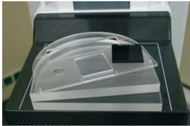
Abb. 4: Prüfaufbau 46 mm PMMA mit PMMA-Einsatz (Prüfpunkt 7.7.2.1: Variation der Objektdicke und der Aufnahmebedingungen bei Belichtungsautomatik).
